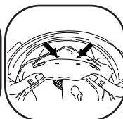
Nackenschutz einschieben und Schiene an den beiden Öffnungen befestigen
